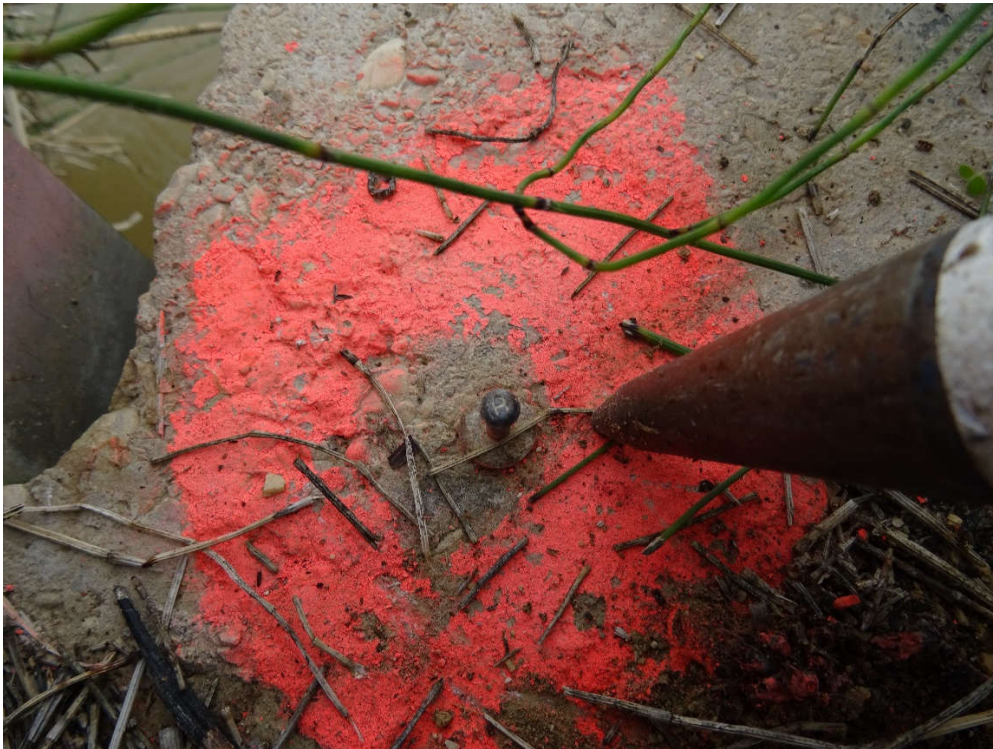
Figura 10: Clavo de acero tipo SPIT utilizado para la señalización general CHE2012
