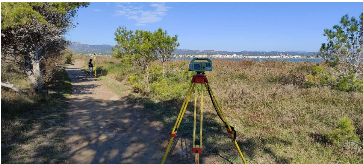
Figura 5: Nivel LS10 observando hacia una mira invar GPCL2.
