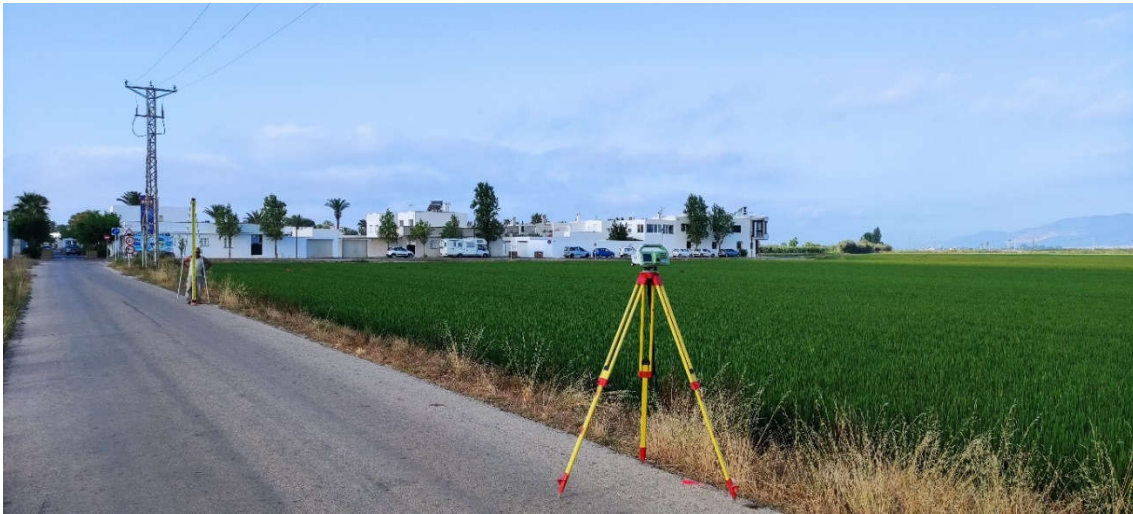
Figura 4: Nivel LS10 observando hacia una mira invar GPCL3.
