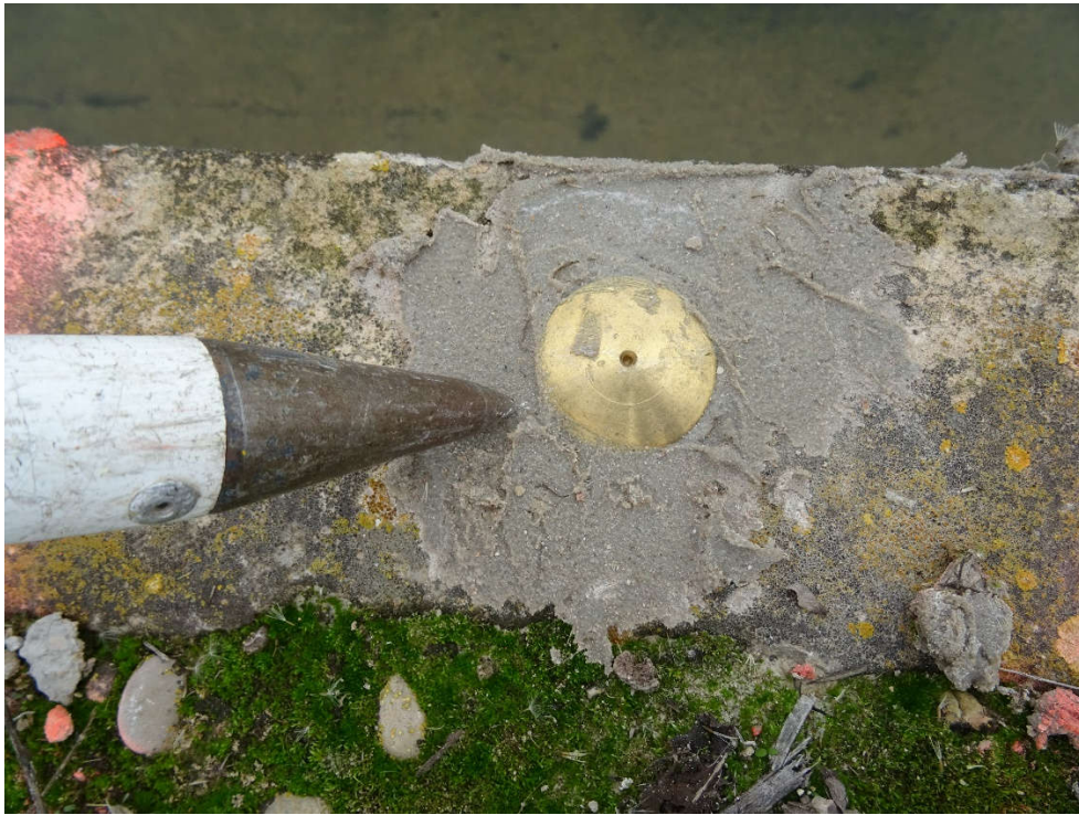
Figura 9: Clavo de bronce de cabeza semiesférica utilizado para la señalización principal CHE2012
