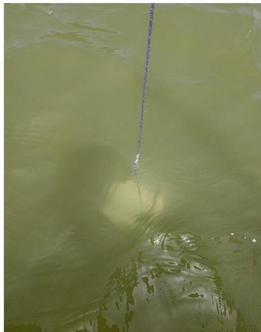
**Figura 8.** Vista del color del agua mediante el disco de Secchi.
