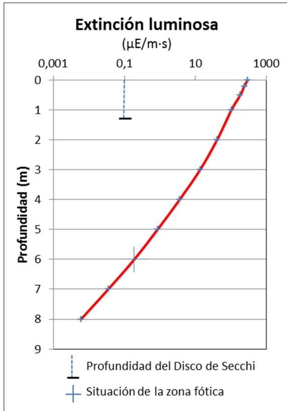
La transparencia del agua registrada en la lectura del disco de Secchi (DS) es de 1,2 m, lo que supone una profundidad de la capa fótica en torno a 3,0 metros. Sin embargo, la capa fótica determinada con medidor fotoeléctrico es de 4 m.
