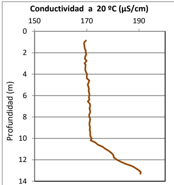
La conductividad del agua es de 160  $\mu\text{S}/\text{cm}$  en la superficie y de 190  $\mu\text{S}/\text{cm}$  en el fondo.
