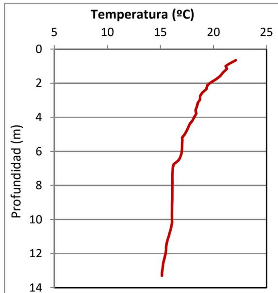
La temperatura del agua oscila entre los 15,13 °C – en el fondo- y los 22,10 °C - máximo registrado en superficie-. En el momento del muestreo (Julio 2017) no se observa termoclina.
