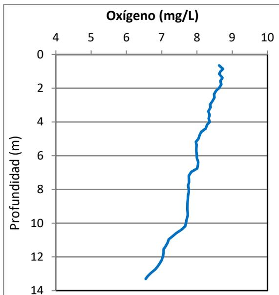
Las condiciones de oxigenación de la columna de agua alcanzan en el muestreo una concentración media de 7,85 mg/L. No se han detectado condiciones anóxicas ( $<2 \text{ mg O}_2/\text{L}$ ).
