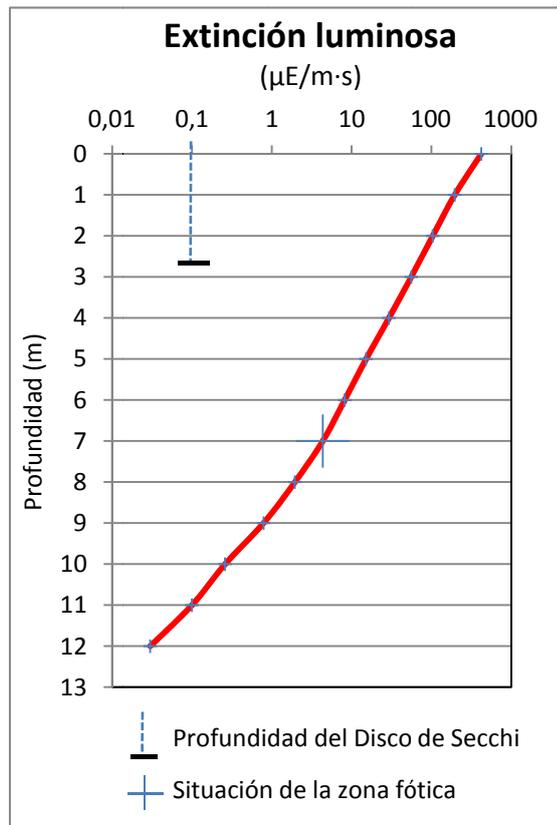
La transparencia del agua registrada en la lectura del disco de Secchi (DS) es de 2,70 m, lo que supone una profundidad de la capa fótica en torno a 6,8 metros. Valor muy similar al registrado con medidor fotoeléctrico de 7 m de profundidad.
