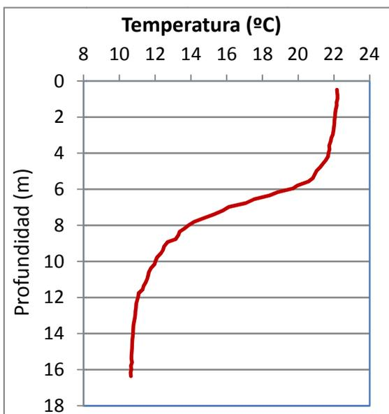
La temperatura del agua oscila entre los 10,64 °C – en el fondo- y los 22,17 °C - máximo registrado en superficie-. En el momento del muestreo (Agosto 2014) la termoclina se sitúa entre los 5 – 9 metros de profundidad.
