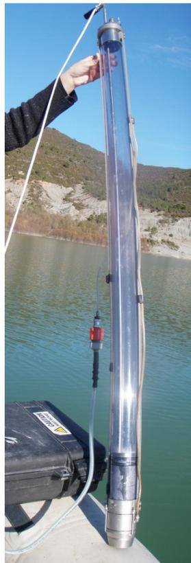
**Imagen 2.** Muestreador *Beaker*, para la toma de muestras en profundidad.
