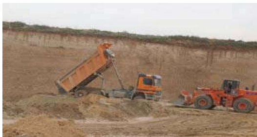
Ilustración 72: Relleno de huecos con estériles
