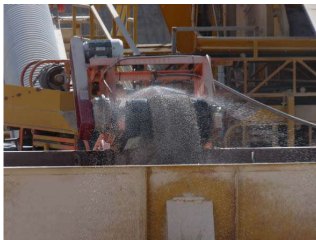
Ilustración 45: Lavado de la grava
