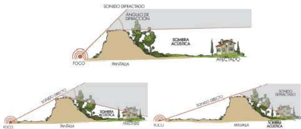
Ilustración 66: Influencia de las pantallas sobre la fuente sonora
