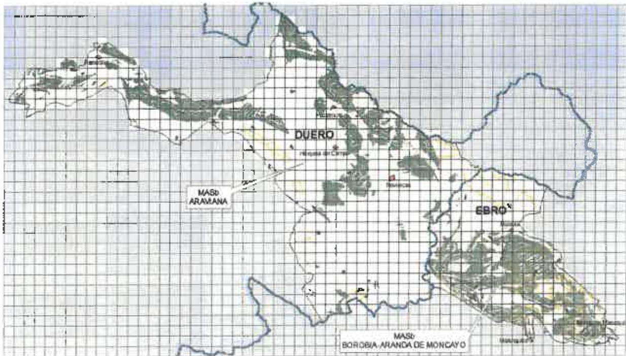
**Figura 5.6. Malleo y límites del modelo para la determinación de la recarga y del funcionamiento hidráulico mediante el código RENATA.**
