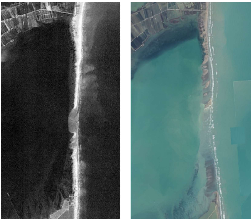
Figura 10. Rotura de la barra del Trabucador en 1990 (izquierda) y 2020 (derecha). FUENTE: Estudio de base CCDE 2008 i ICGC.
