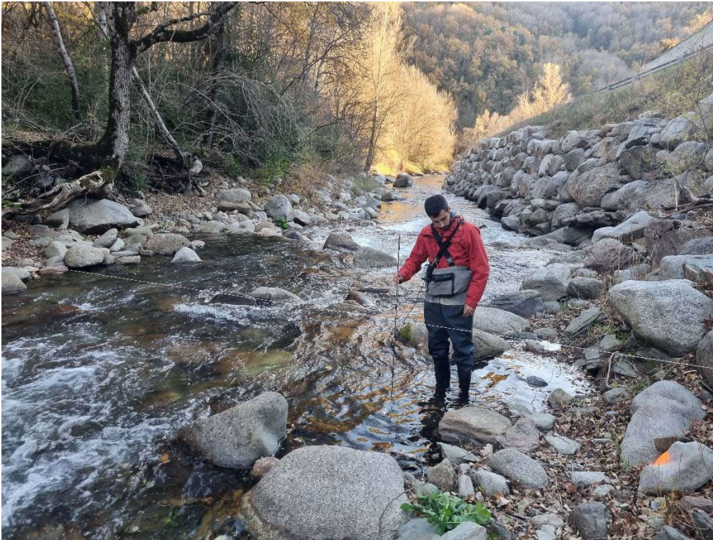
Figura 35. Toma de datos de aforo en sección inferior en aguas altas.
