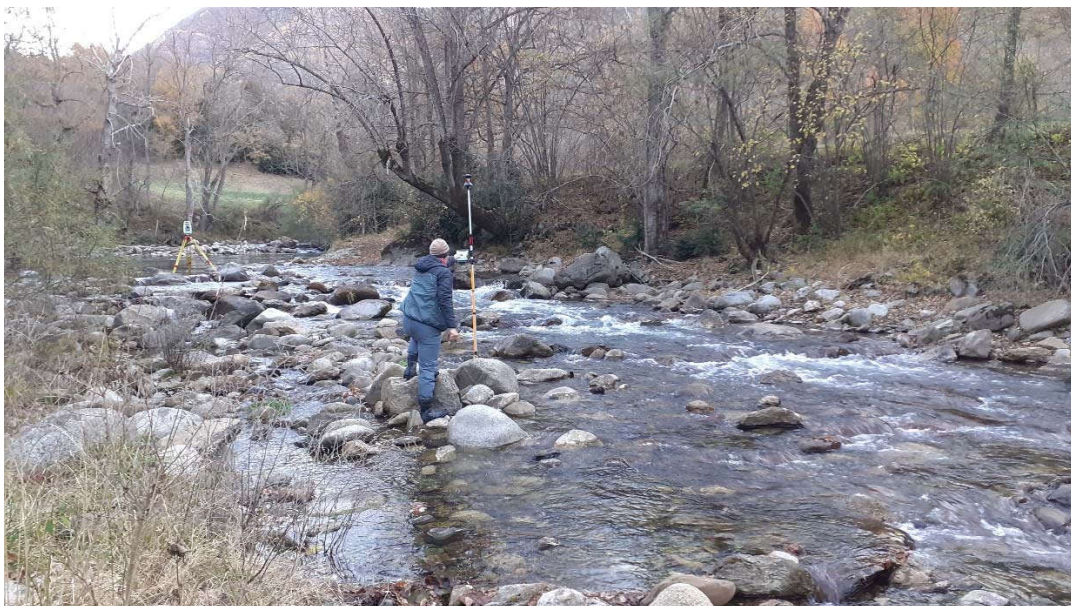
Figura 30. Levantamiento topográfico en sección superior-central en aguas bajas.
