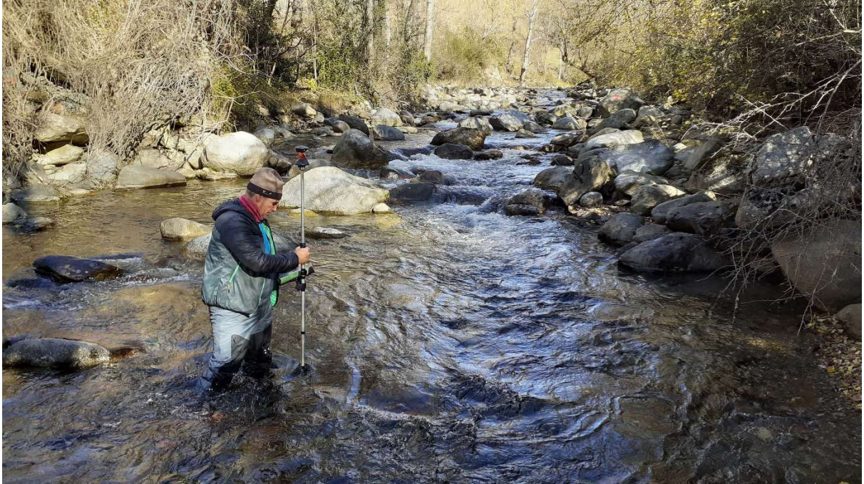
Figura 37. Toma de datos de calado para calibración en aguas altas.
