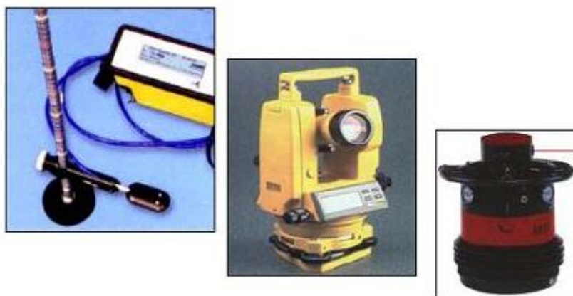
Figura 5. Equipo de trabajo para realizar el levantamiento topográfico y la medición de caudales. A la izquierda corrientímetro, en el centro estación total topográfica y a la derecha nivel láser.
