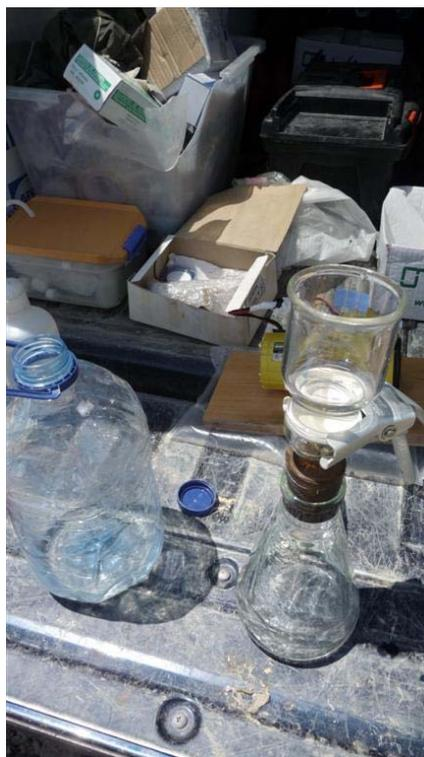
Foto 2: Equipo de filtración
