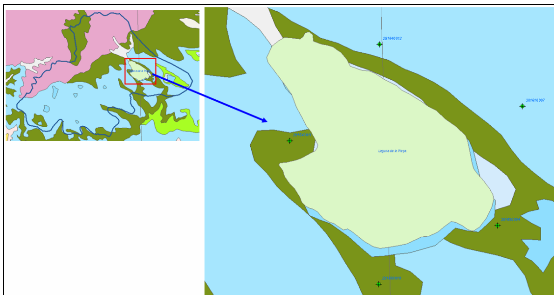
Figura 2. Situación de los puntos de control piezométrico en el entorno de la laguna.
