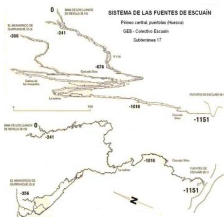
Figura 26. Funcionamiento hidrogeológico del sistema cárstico Fuentes de Escuaín (tomado de Puch, C., 2002)
