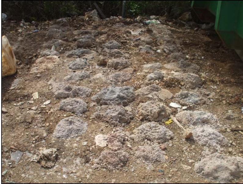
Foto 6. Muestras obtenidas durante la realización del sondeo (desde 200 a 250 m).
