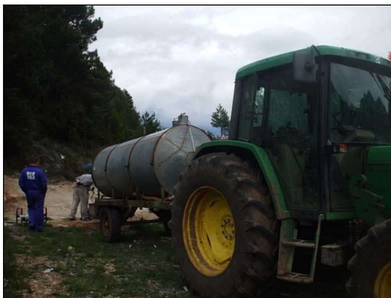
Imagen 1. Depósito utilizado para el ensayo de inyección.
