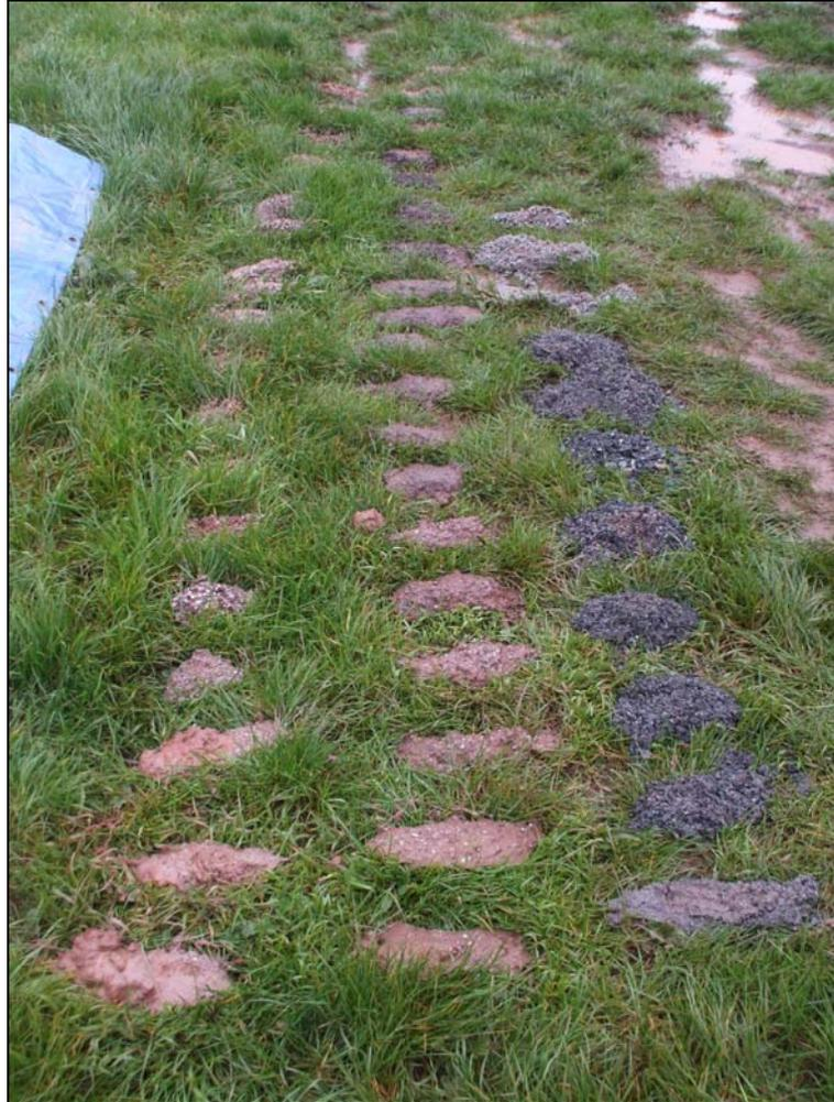
**Imagen 4.** Muestras obtenidas durante la perforación del sondeo de Prades.
