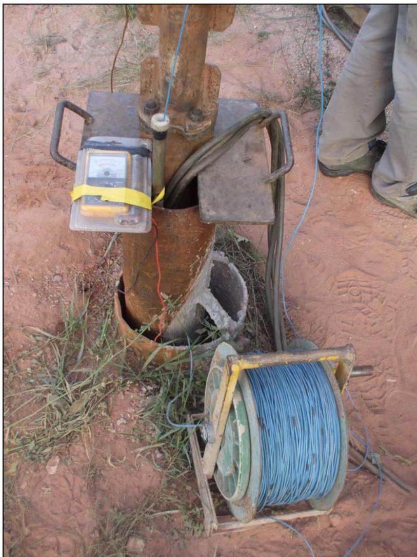
*Imagen 4. Sonda hidronivel en el pozo ensayado.*
