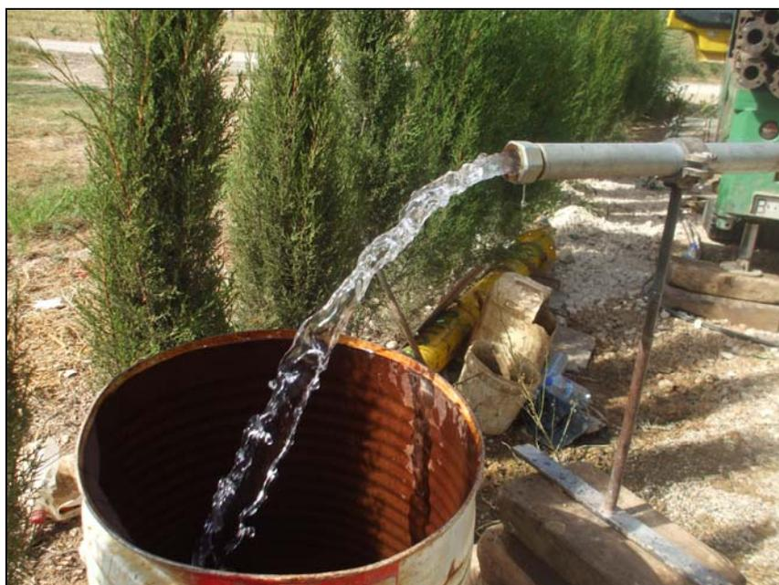
**Imagen 10.** Caudal extraído durante el octavo escalón (escalón de larga duración).
