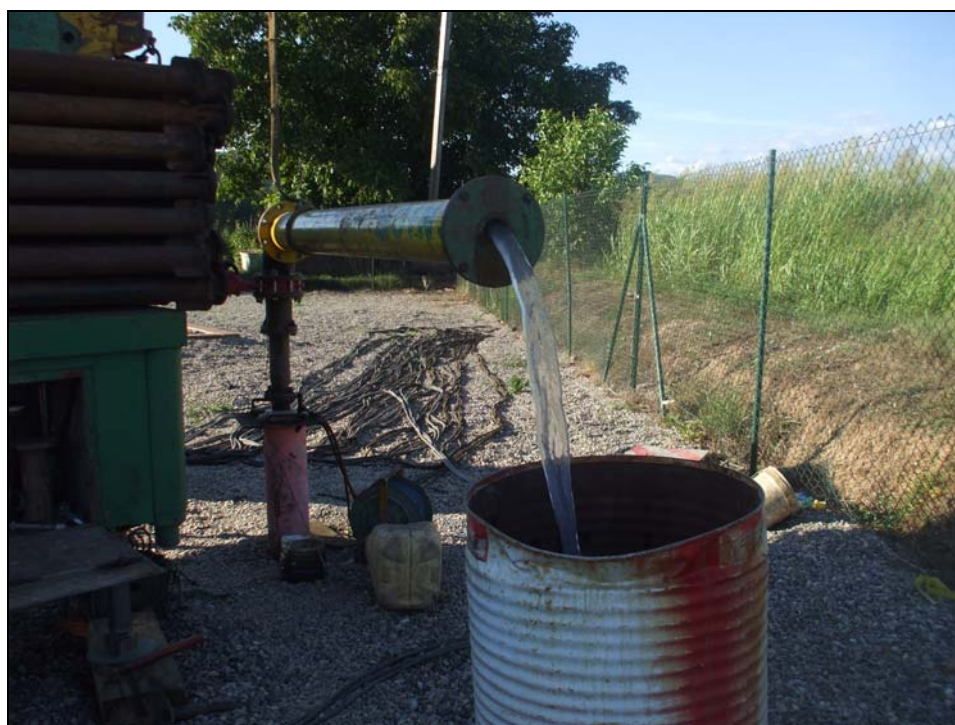
Imagen 8. Caudal extraído durante el cuarto escalón (escalón de larga duración), al inicio del mismo.
