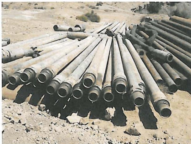
Vista de la tubería utilizada en la circulación inversa
