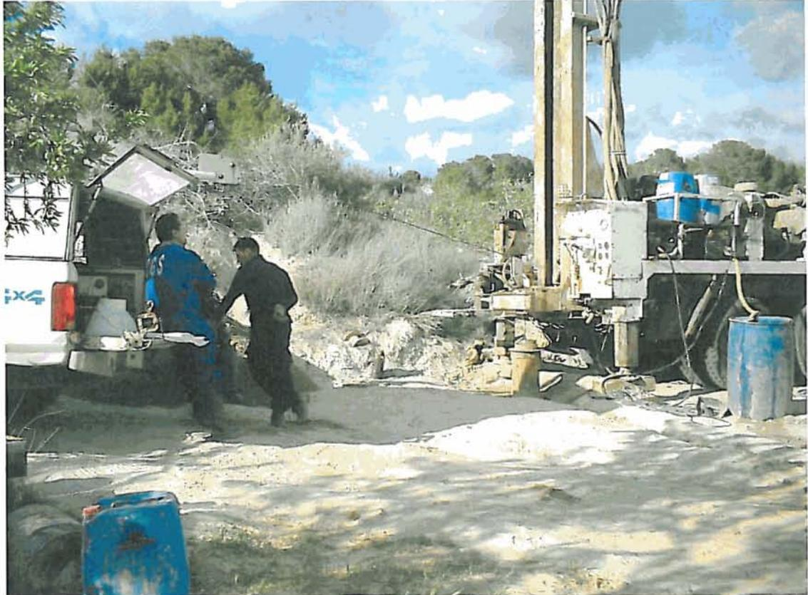
Introducción de la sonda de gamma y desviación.
