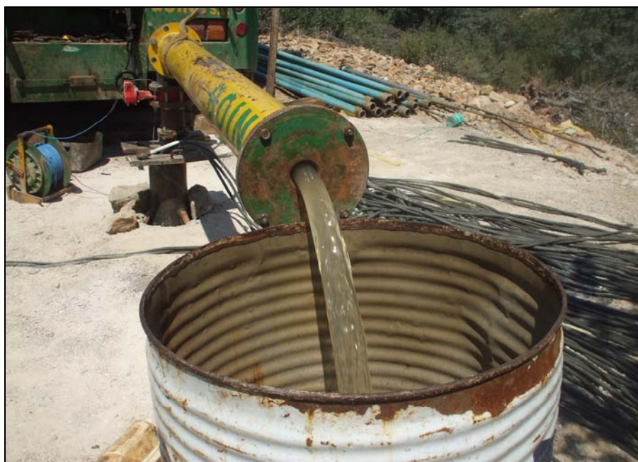
Imagen 3. Caudal extraído a la mitad del tercer escalón.
