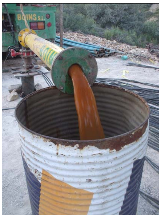
Imagen 2. Caudal extraído al inicio del primer escalón.
