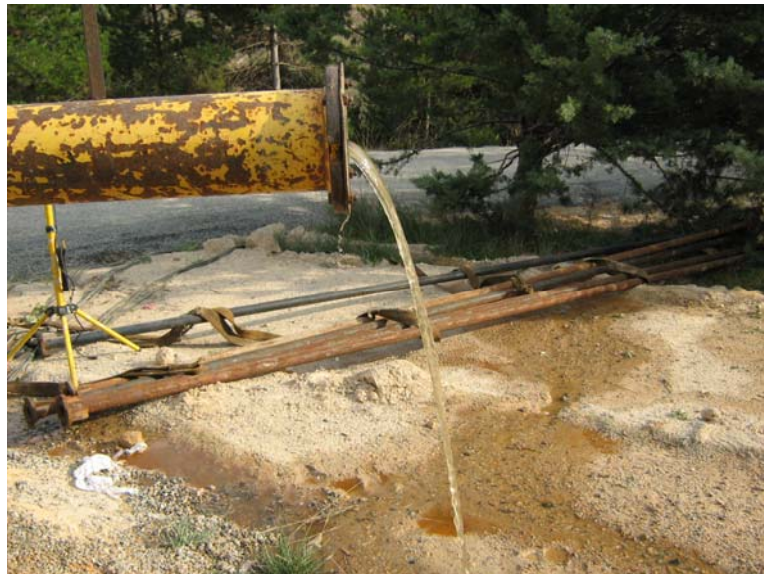
Segundo bombeo a 0,3 l/s
