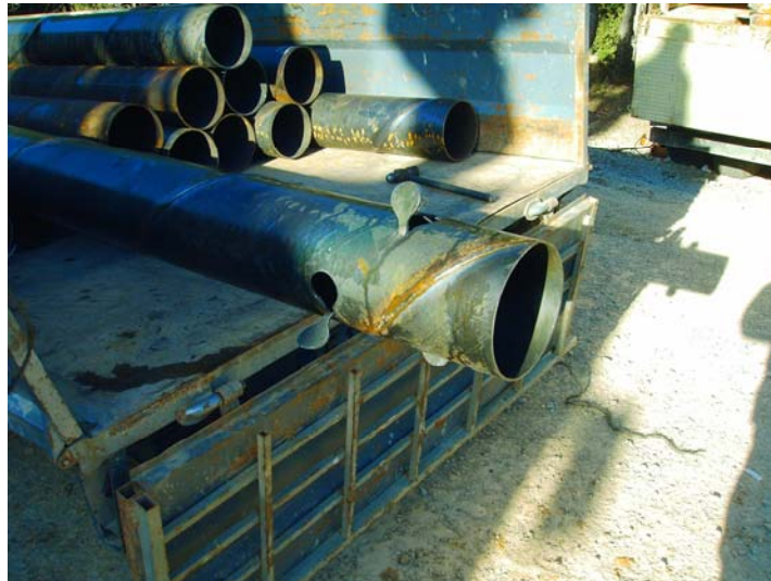
Detalle: tubería ciega con orejetas abiertas
