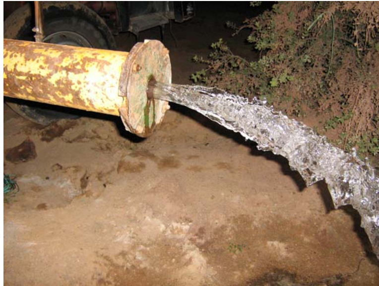
Tercer escalón (agua clara, 4 l/s)
