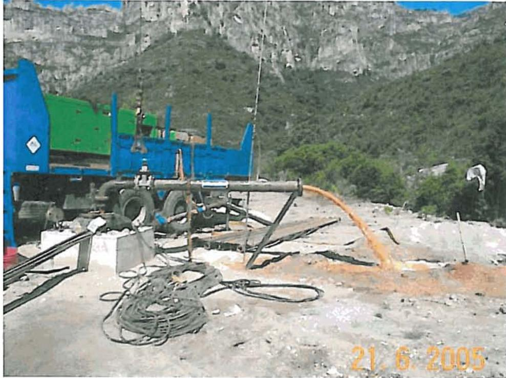
Ensayo de bombeo del piezómetro del Barranco de Lloret
