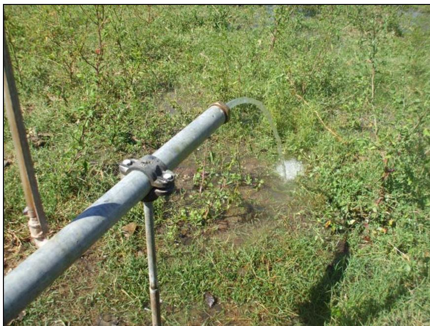
Imagen 6. Caudal extraído durante el cuarto escalón.
