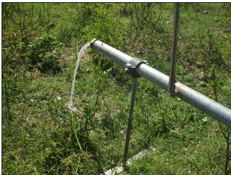
Imagen 3. Caudal extraído durante el primer escalón.
