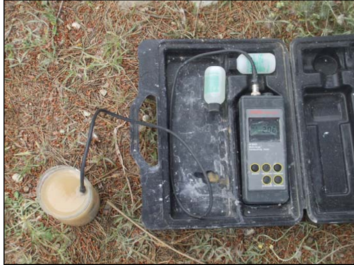
Imagen 8. Medida de la conductividad in situ.
