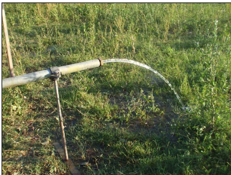
Imagen 4. Caudal extraído durante el segundo escalón.
