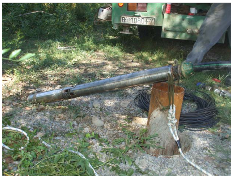
Imagen 1. Detalle de la bomba utilizada durante el ensayo.
