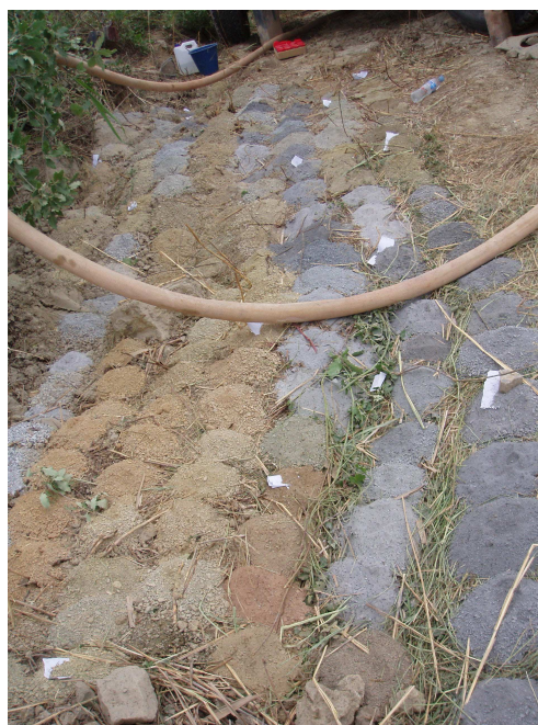
Foto 4. Muestras extraídas durante la perforación del sondeo.
