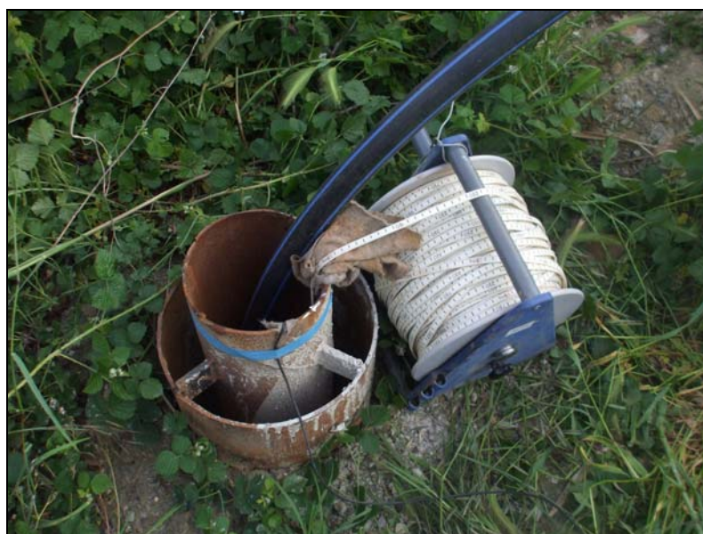
Imagen 2 y 3. Inyección de agua en el sondeo.
