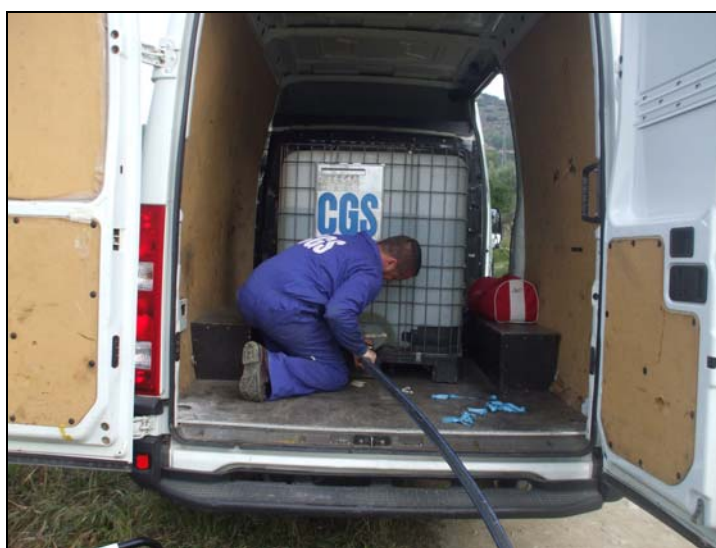
Imagen 1. Depósito utilizado para el ensayo de inyección.
