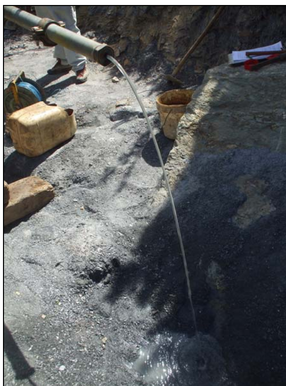
Imagen 3. Caudal extraído durante el segundo escalón (larga duración).
