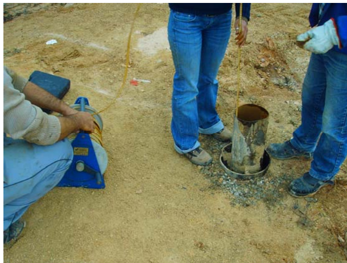
Midiendo nivel con sonda manual
