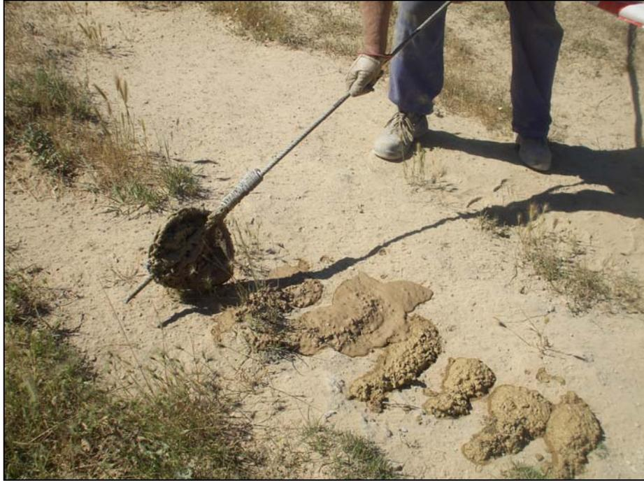
**Imagen 6.** Detalle de la colocación de las muestras extraídas en la realización del sondeo de Sabiñánigo.
