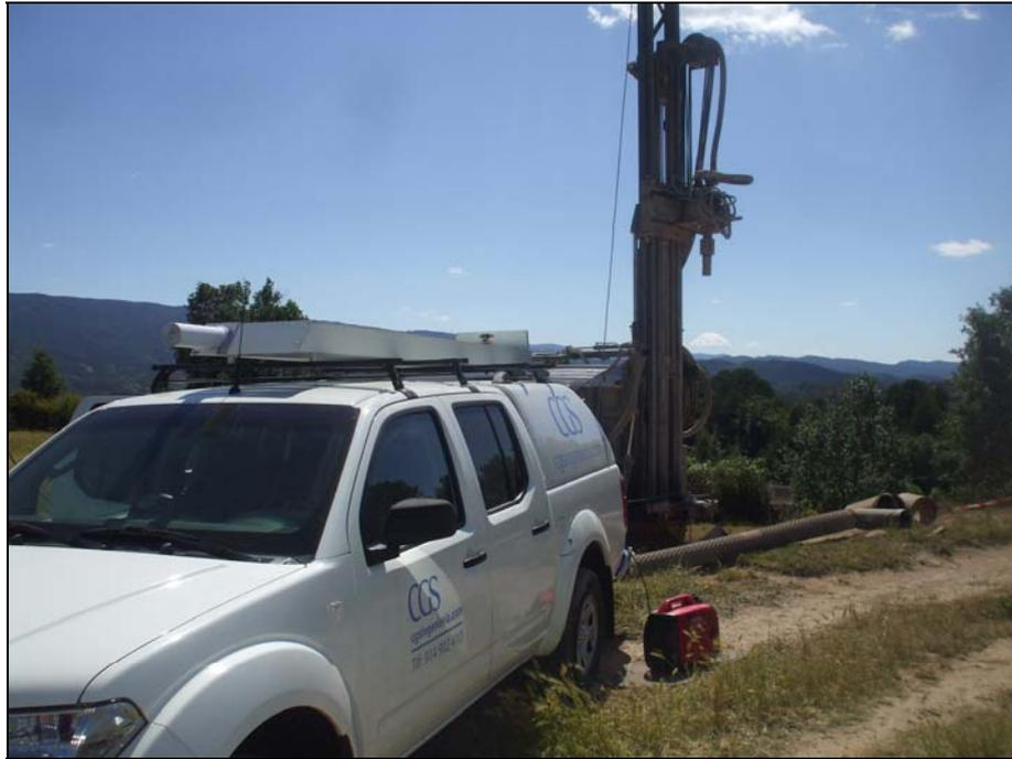
**Imagen 7.** Realización de testificación geofísica.
