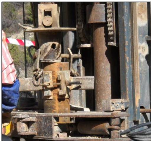
Fig.10. Detalle del dispositivo empleado para bajar la tubería sin necesidad de recurrir a las “orejetas”
