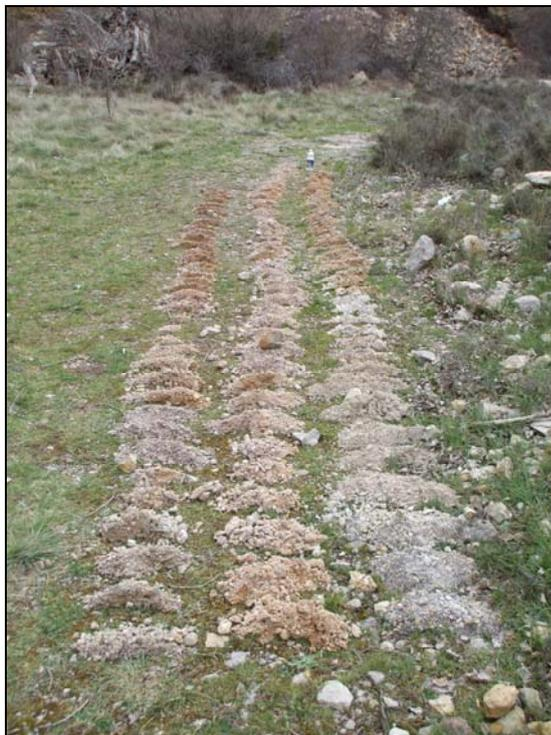
***Imagen 5. Muestras obtenidas durante la perforación del sondeo de Aliaga.***
