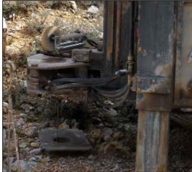
Fig.9 . Detalle del sistema de poleas con el que se realiza la bajada de la sonda de testificación geofísica en el sondeo.
