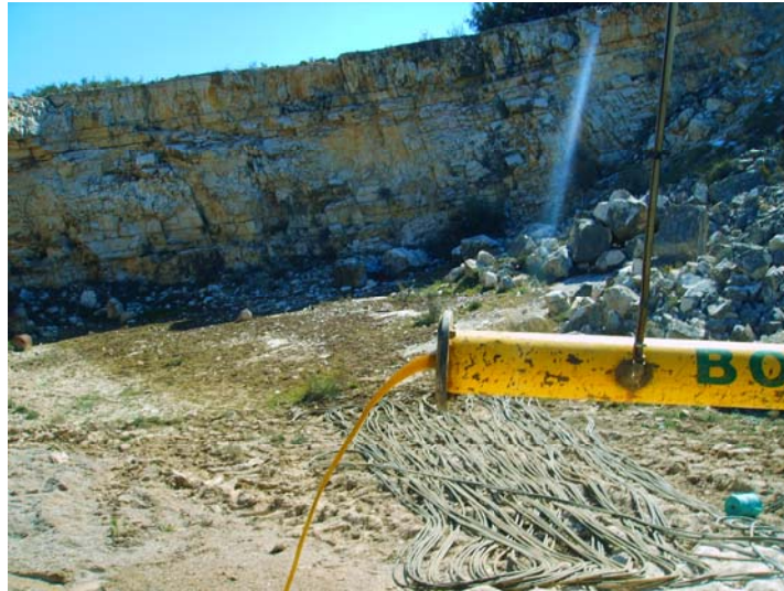
Agua muy turbia al comenzar el aforo. Primer escalón, 1,5 l/s.
