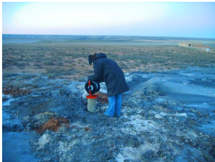
Midiendo nivel con sonda manual
