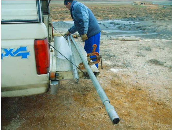
Sondas hidrogeológica y de desviación
