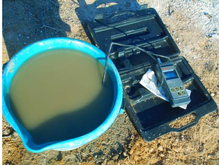
Midiendo conductividad del agua del sondeo
