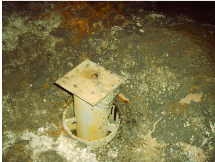
Sondeo tapado con chapa metálica (agujerito en el centro para medir mañana de nuevo el nivel)
