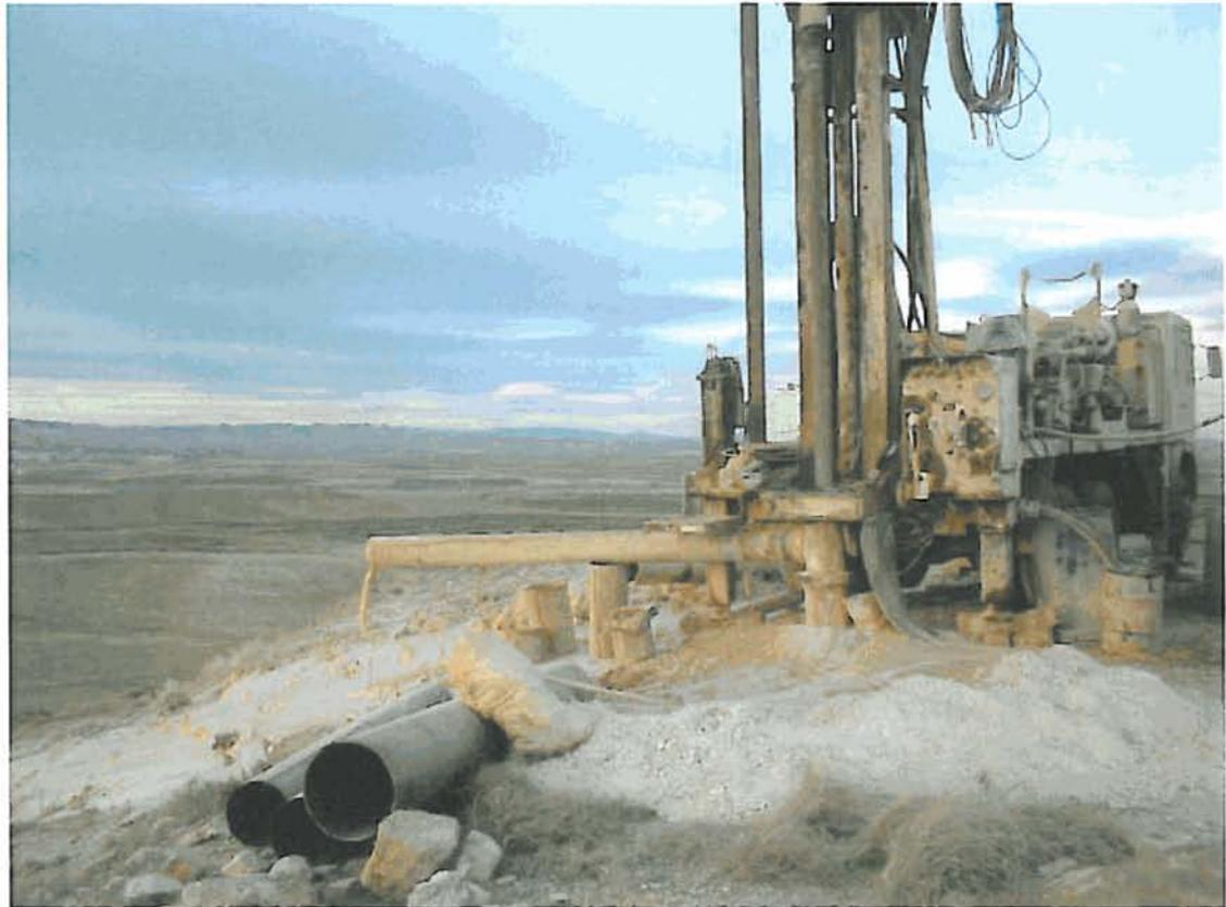
Perforación a los 190 metros. Se aprecia como se pierde parte del barrido.
