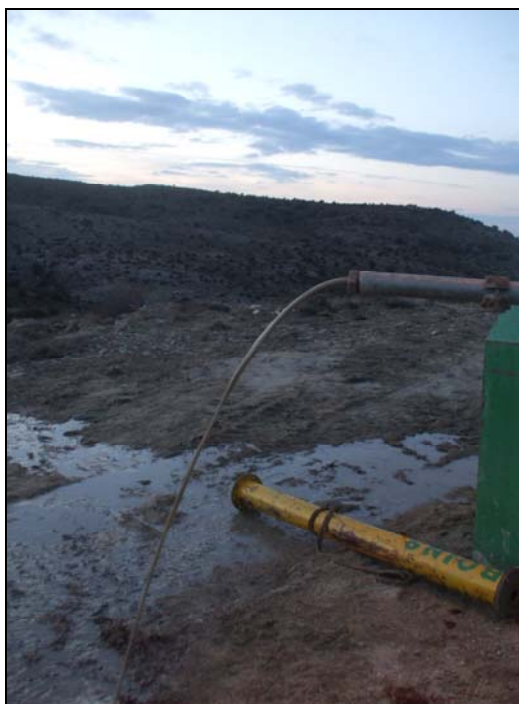
Imagen 2. Caudal extraído durante el primer escalón.
