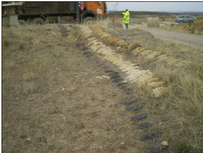
Imagen 6. Muestras obtenidas durante la perforación del sondeo de Anadón.
