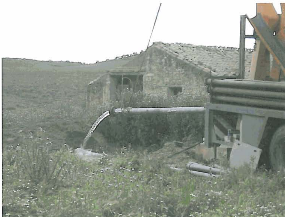
Agua turbia en el inicio del ensayo y clara con 17 l/sg.
