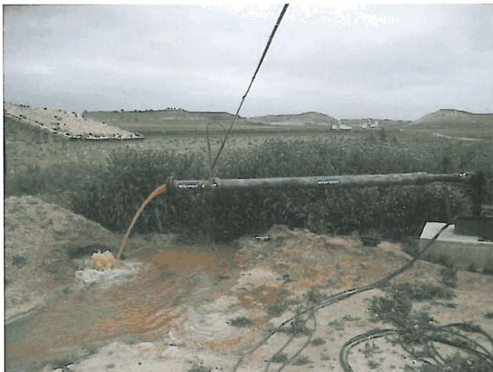
Agua turbia en el inicio del ensayo y clara con 17 l/sg.
