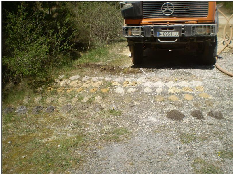
**Imagen 4.** Muestras obtenidas durante la perforación del sondeo.
