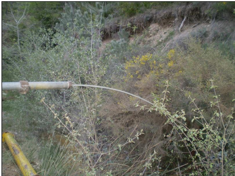
***Imagen 5. Caudal al final del escalón del escalón de larga duración.***
