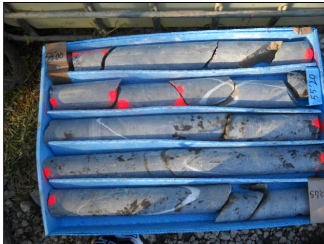
Fig.8. Detalle de las calizas fracturadas atravesadas a partir del metro 57.
