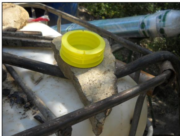
Fig.14. Detalle de la Pieza usada para realizar el aislamiento del sondeo.
