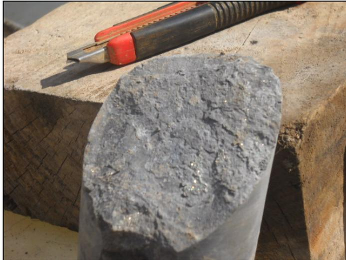
Fig.7. Detalle de los cristales de Pirita entre las margas
