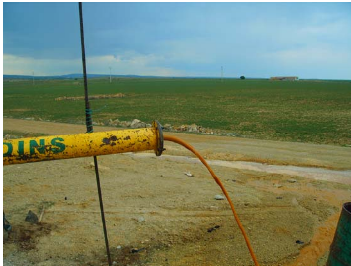
Agua muy turbia al comenzar el aforo
