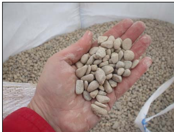
Imágenes 10. Engravillado del sondeo.
