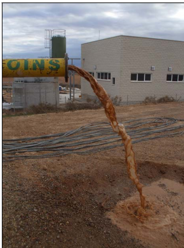
Imagen 4. Caudal extraído durante el segundo escalón (inicio).
