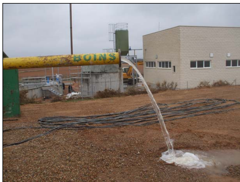
Imagen 7. Caudal extraído durante el cuarto escalón (escalón de larga duración).
