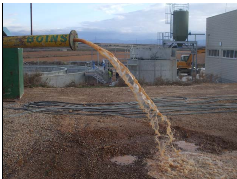
Imagen 5. Caudal extraído durante el segundo escalón (final).
