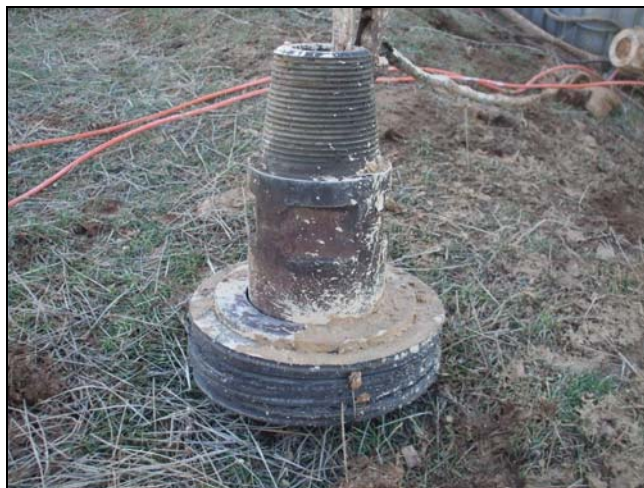
Imagen 9. Pistón utilizado para cementar el sondeo.
