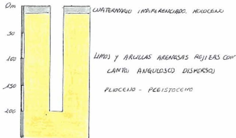
Figura 3. Corte geológico y columna prevista para el piezómetro de Cariñena – Aguarón
