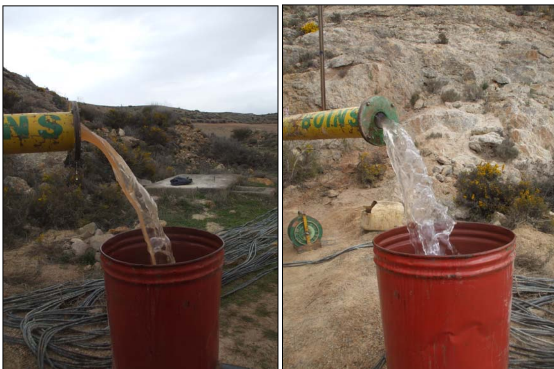
Imágenes 5 y 6. Caudal extraído durante el segundo escalón.
