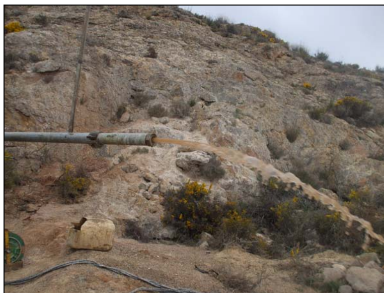
Imagen 4. Caudal extraído durante el primer escalón (final).
