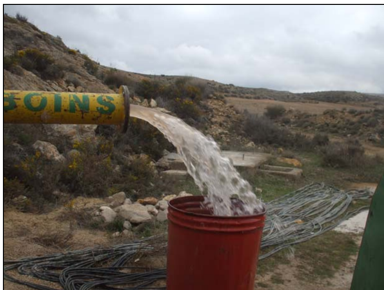
Imagen 7. Caudal extraído durante el tercer escalón.
