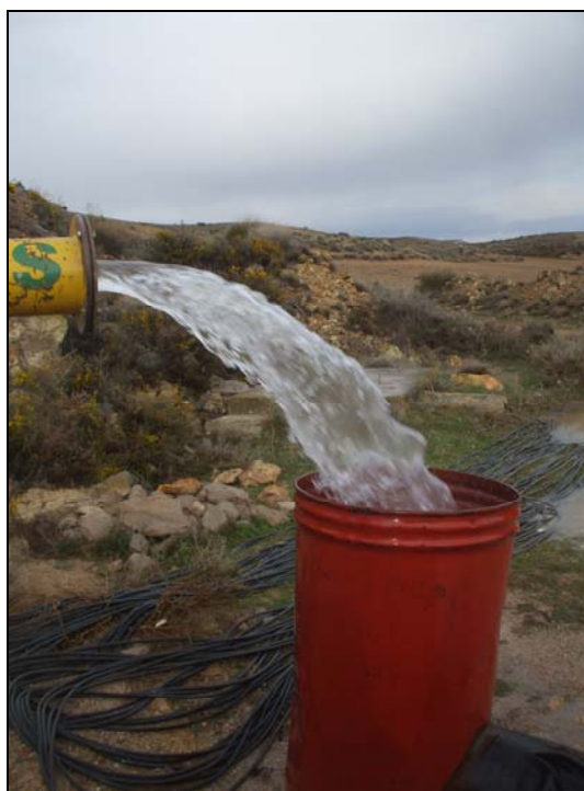
Imagen 8. Caudal extraído durante el cuarto escalón.
