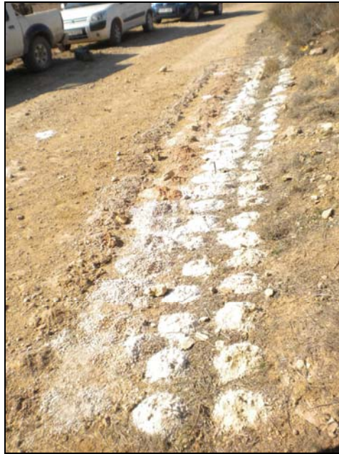
Imagen 4. Muestras extraídas en la realización del sondeo de Épila.
