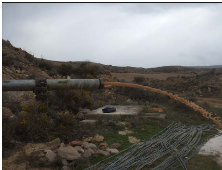
Imagen 3. Caudal extraído durante el primer escalón (inicio).
