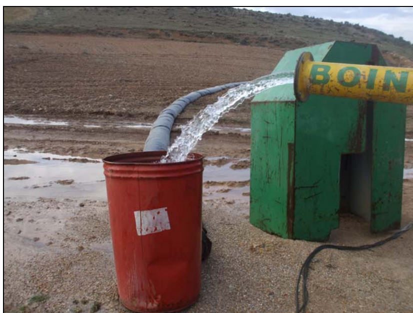
Imagen 9. Caudal extraído durante el sexto escalón (escalón de larga duración).
