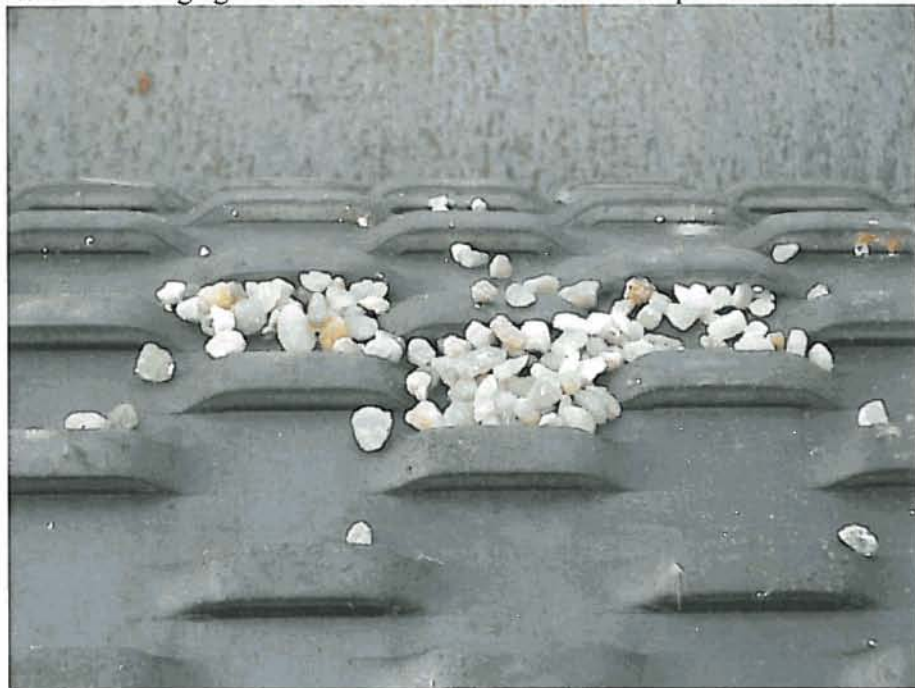
Detalle de cómo el diámetro mínimo de la gravilla es, claramente mayor a las aberturas regulares de la tubería puentecillo (1,5 mm)
