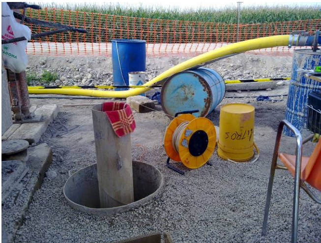
Ensayo de bombeo. Medida piezométrica pozo 2 (piezómetro)
