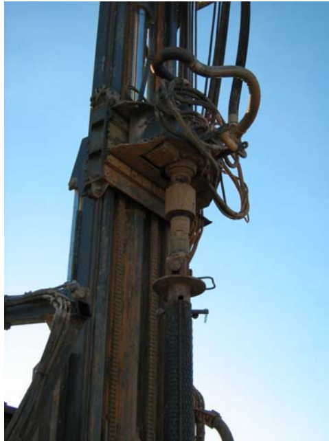
Detalle cabezal y tubería de filtro
