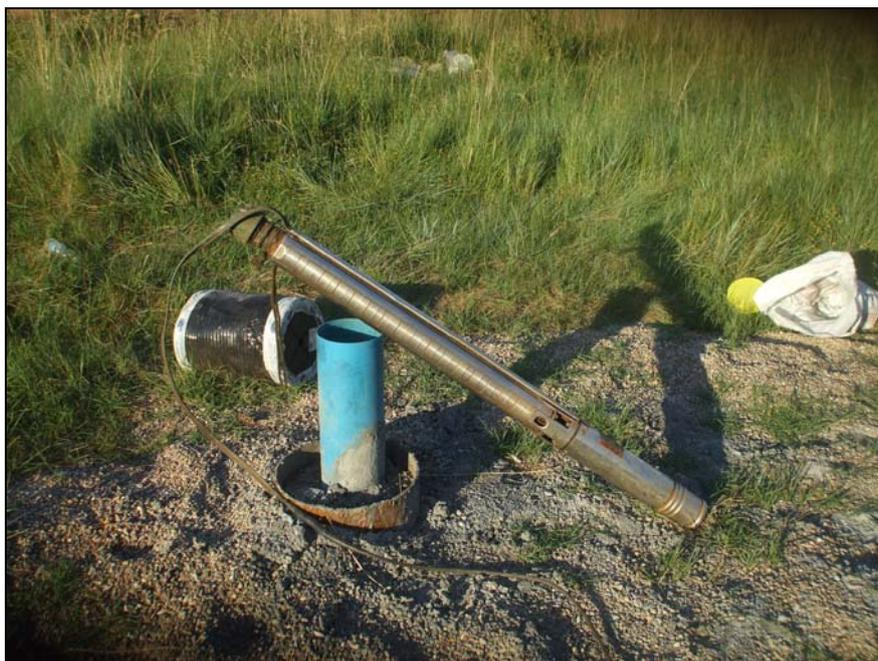
*Imagen 2. Bomba utilizada para el ensayo de bombeo.*
