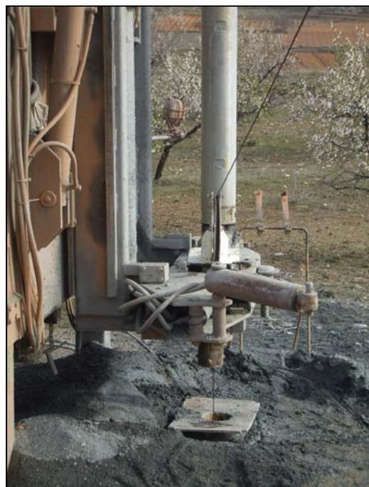
**Fotos 7 y 8.** Introducción de la sonda y realización de la testificación geofísica.
