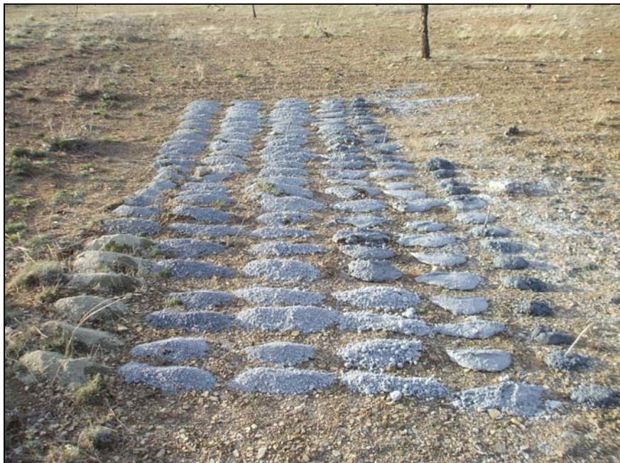
**Foto 6.** Muestras extraídas durante la perforación del sondeo..
