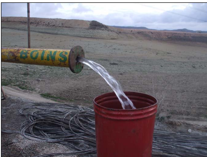
Imagen 7. Caudal extraído durante el tercer escalón.
