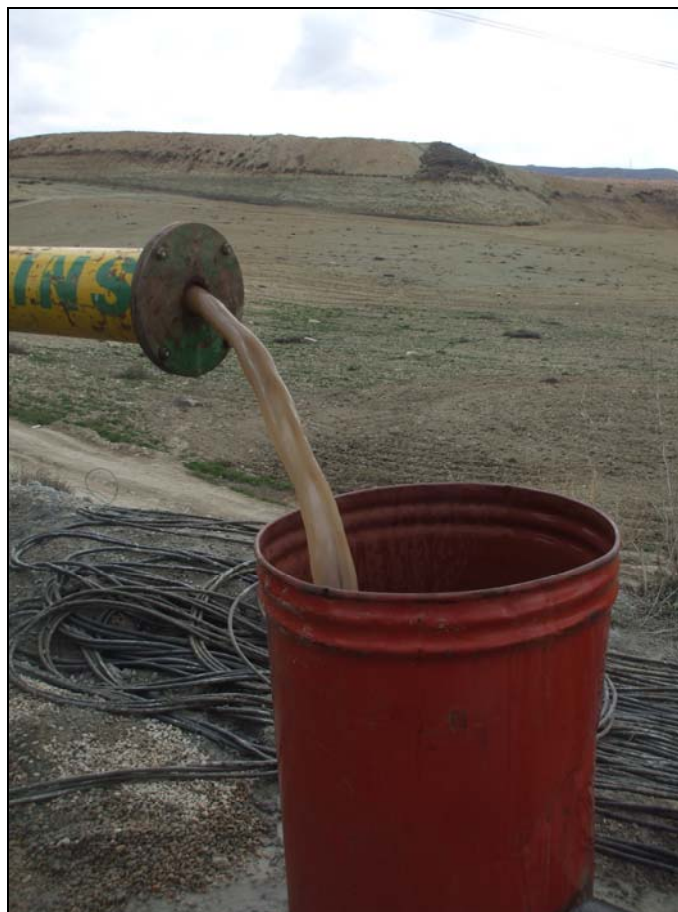
Imagen 5. Caudal extraído durante el primer escalón.
