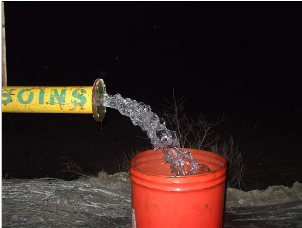
Imagen 8. Caudal extraído durante el cuarto escalón.
