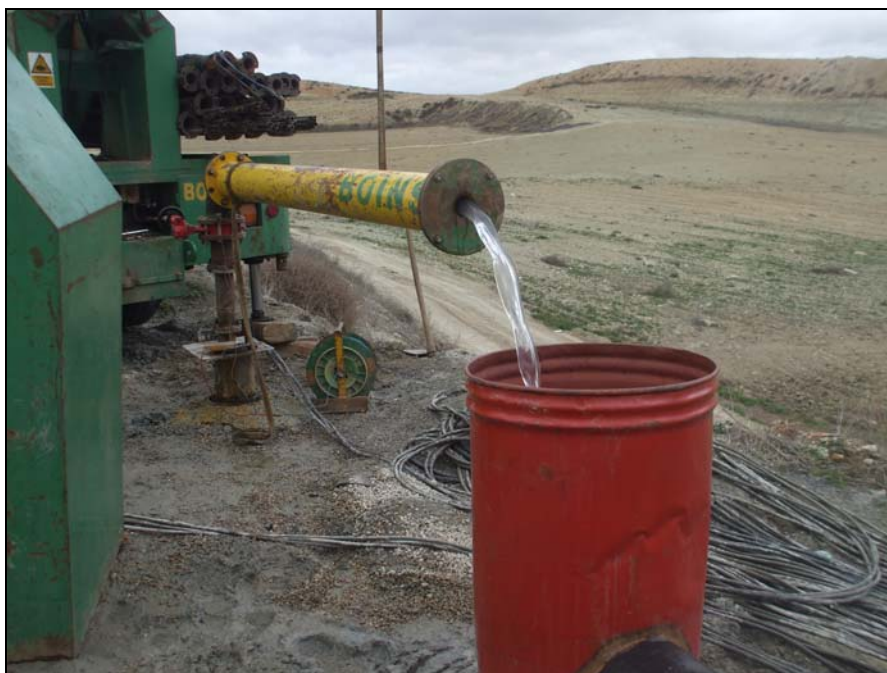
Imagen 6. Caudal extraído durante el segundo escalón.
