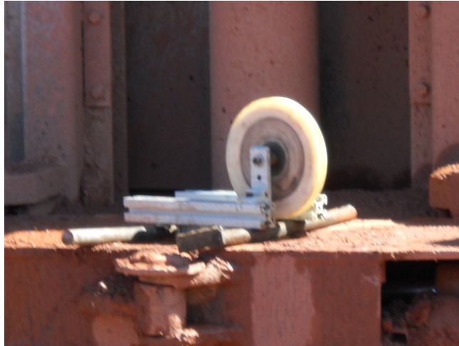
Fig,8. Detalle del dispositivo empleado para bajar las sondas de Geofísica.
