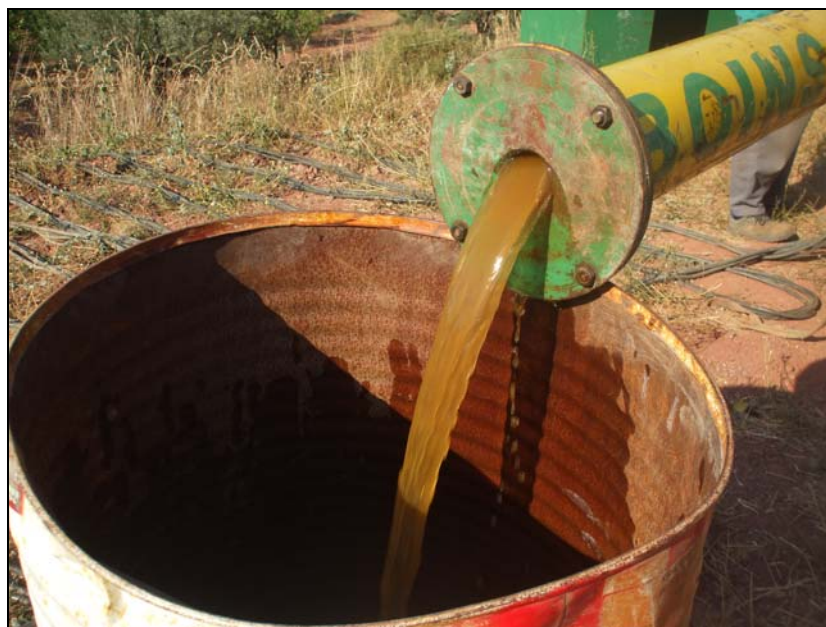
Imagen 2. Caudal extraído durante el primer escalón
