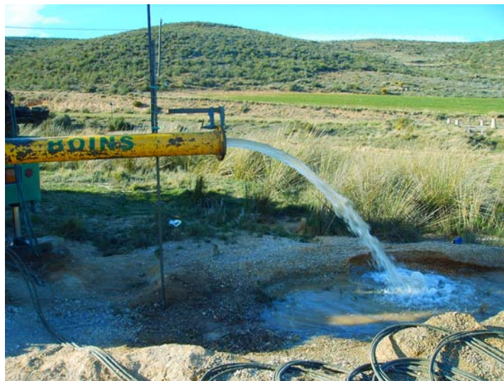
Tercer escalón (9l/s)
