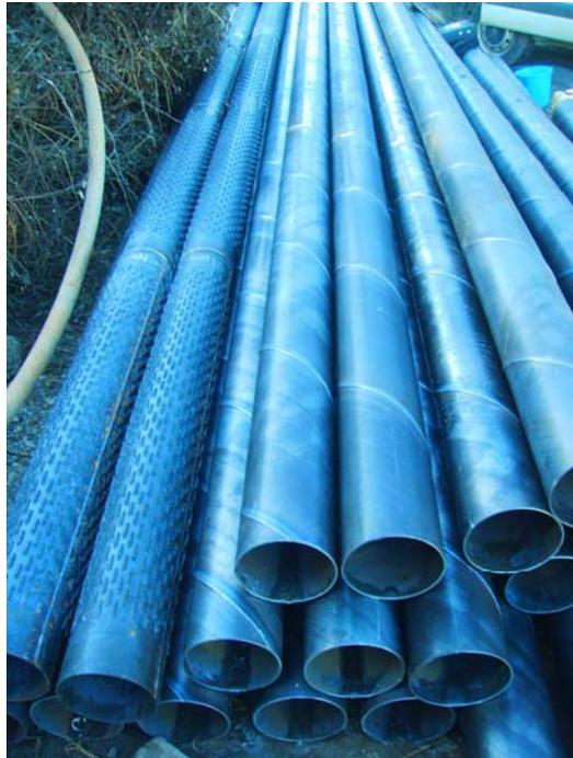
**Tubería definitiva (ciega helicoidal y filtrante tipo "puentecillo")**
