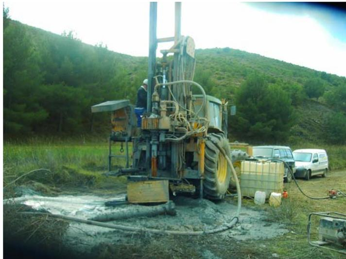
**Perforando con el martillo de 220 mm (a los 60 m de profundidad)**
