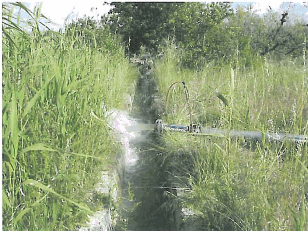
Ensayo de bombeo. Caudal = 24,9 l/s.
